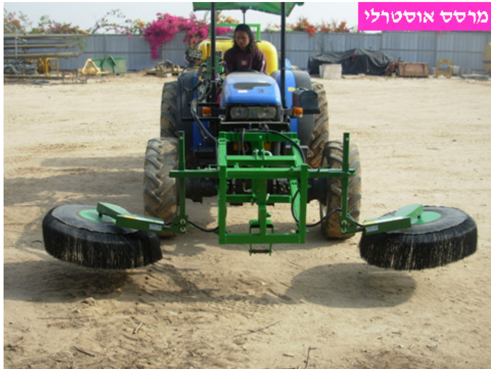
תמונה 7: מרסס אוסטרלי, מכיל שתי צלחות המרססות את כתפי השורות ברוחב של 90 ס"מ.
