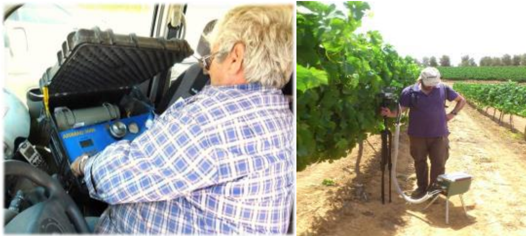
איור 6. מדידת חילוף גזים במערכת Li-Cor 6400 במהלך יום פיזיולוגיה בחלקת שיראז (ימין) ומדידת פוטנציאל מים בגזע בצהרי היום באמצעות תא לחץ (ARIMAD 3000 מ.ר.סי, חולון) (שמאל).
