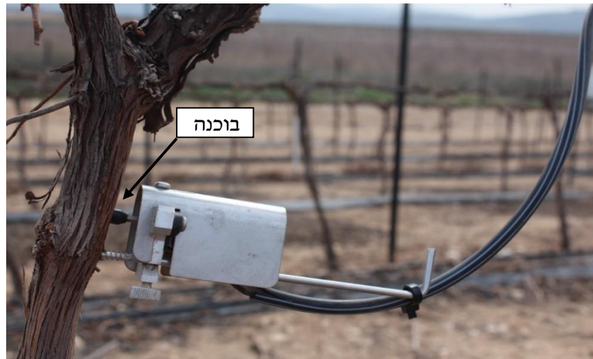
איור מס' 6: דנדרומטר מותקן על גפן מדידה. ניסוי מרווחי השקיה מרלו, מבוא חורון 2014-2015.
