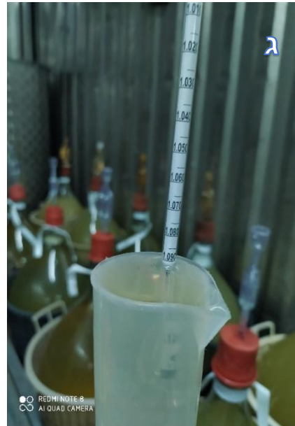
איור מס' 4 - שלבים בהכנת יין לבן. א מכשיר הקראשר דיסטימר (מועך מפריד) בין הענבים עצמם לשורות. ב מכשיר המכבש. מסנן את המיץ מהקליפות. ג מדידת צפיפות על ידי הידרומטר. ד שפיית היין להוצאת המשקעים.
