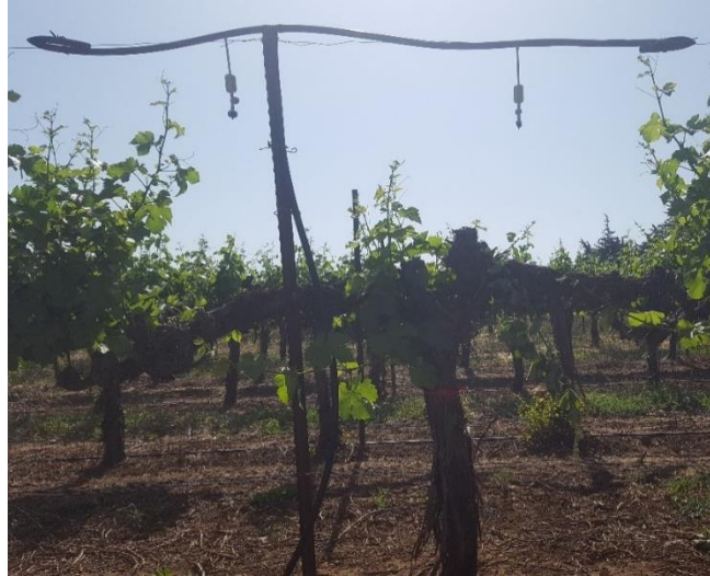
איור 2 : צילום של מערכת ההתזה כפי שהוצבה מעל אחת הגפנים בחלקה באלרום (צילום: 28/05/2019). הגפן בתמונה שייכות לקבוצת הטיפול של הדמיית הגשם מחוץ לעונה.
